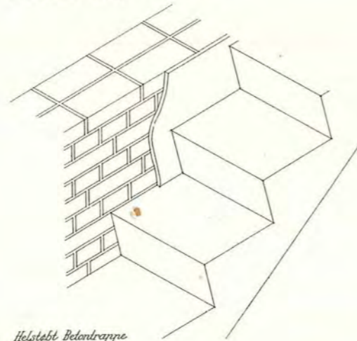
Trin af Beton, oplagt paa bærende Plade
